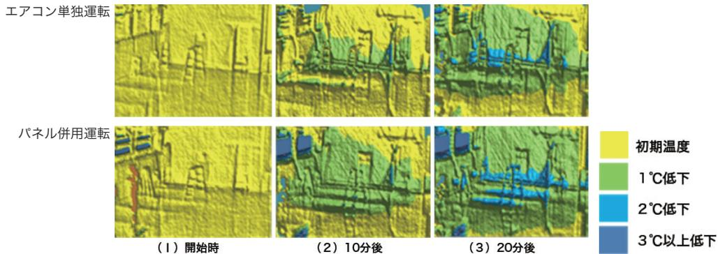
図4 エアコンとパネルの表面温度変化
