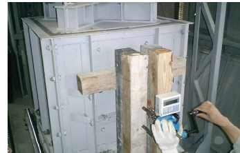
アンカー部材引抜試験状況
