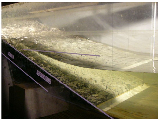
斜面被覆材安定実験状況
