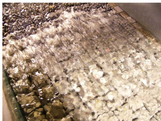
斜面被覆材安定実験状況
